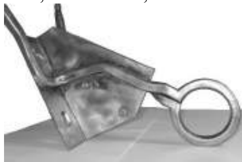
Рис. 3. Одновитковый индуктор для термообработки внешних поверхностей
