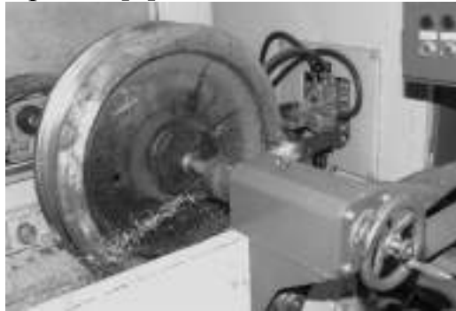
Рис. 1. Электротехнологическая установка для закалки реборды шкива кранового колеса
